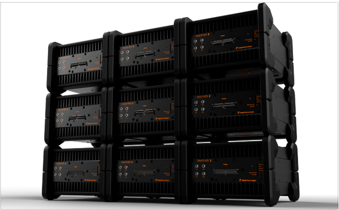
Panther 2可以串联起来，同时驱动256个元件，最多可并行驱动16个单元。
